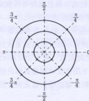
图5 测量辐射场均匀性的测量点位置
