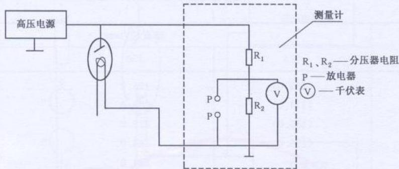
图 8 测量计法电气联结图
