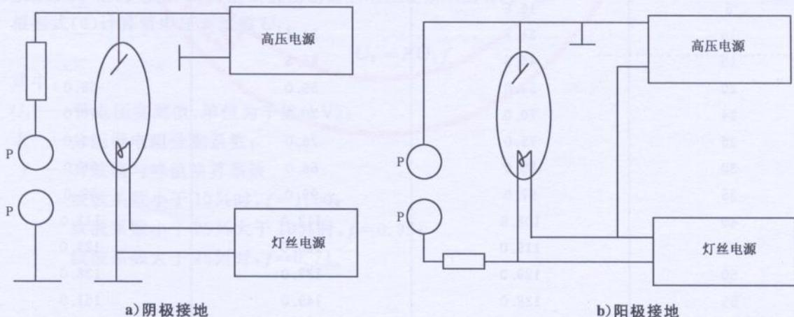
图 7 球隙放电法电气联结图
